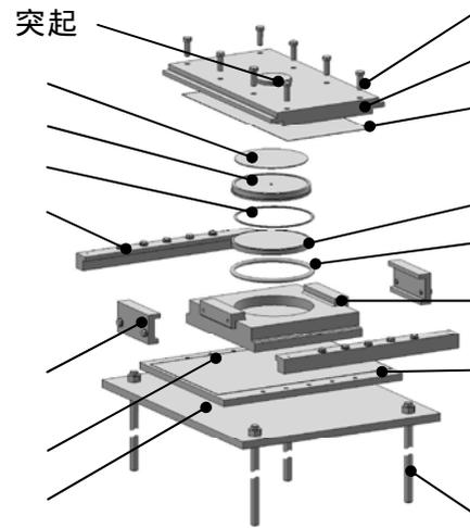
図 4 BP.B 支承 2 方向移動型の構造図
