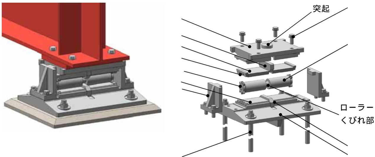
図 11 1本ローラー支承の構造図
