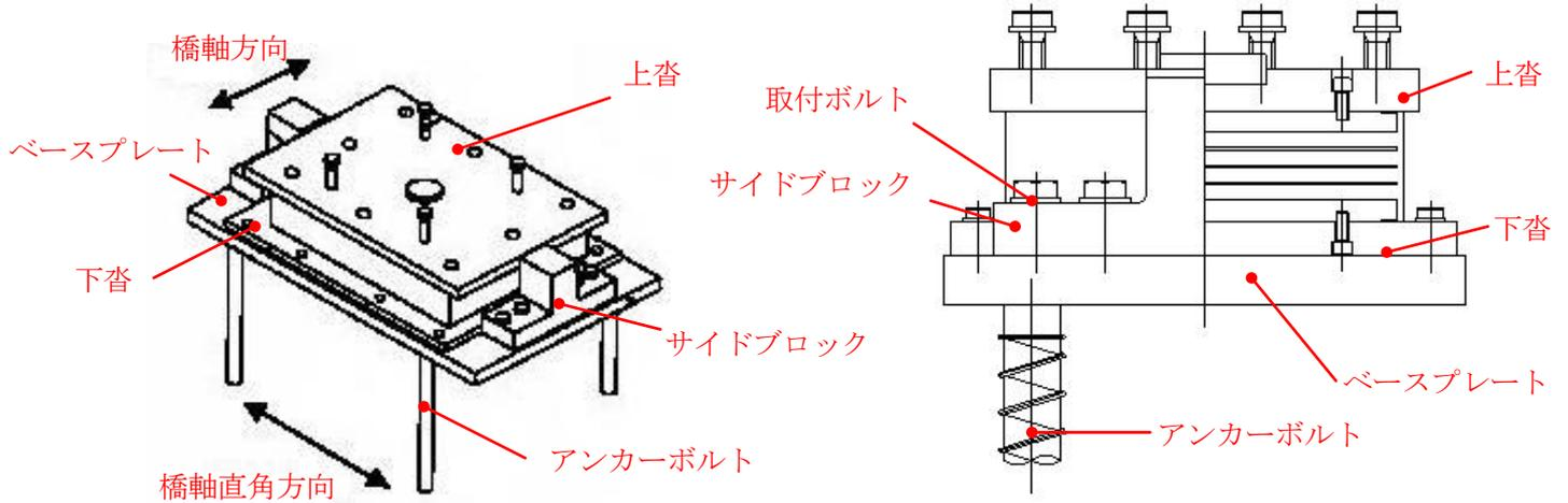
図-1 水平力分散型ゴム支承の構造例
